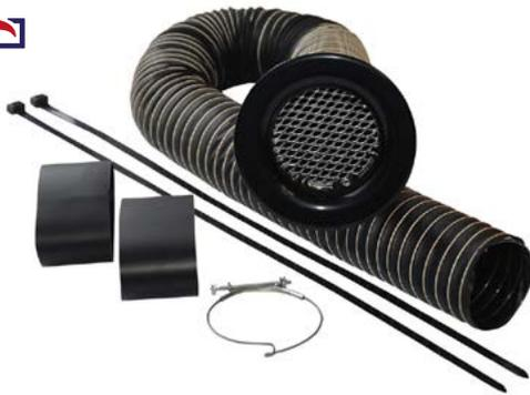
Packs d'admission d'air conçus pour alimenter en air frais le radiateur d'huile additionnel réf. 1821000 afin de réguler la température de l'huile moteur, en évitant toute surchauffe. Ils peuvent également être utilisés comme refroidisseur d'habitacle, ce qui permettra de conserver une température idéale à l'intérieur du véhicule lors de conditions extrêmes.
