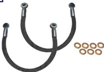
Pack spécialement étudié pour la lubrification des culasses. Fabriqué à partir de durites flexibles de type "aviation" et de raccords Banjo en acier nickelé, il remplace le tuyau de graissage d'origine qui peut être sujet à des ruptures dues aux effets de la corrosion et des vibrations. Ce pack de graissage est idéal pour ceux qui préparent un moteur à la compétition ou qui recherchent une fiabilité accrue.
