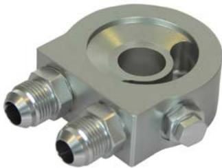
Platine sandwich spécialement étudiée pour un montage simplifié entre le carter moteur et le filtre à huile. Deux réservations spécifiques sont prévues, la première pour la pose d'un capteur de température d'huile et la seconde pour un capteur de pression d'huile. La conception de cette platine offre également la possibilité de monter un refroidisseur d'huile additionnel grâce aux orifices prévus à cet effet.
