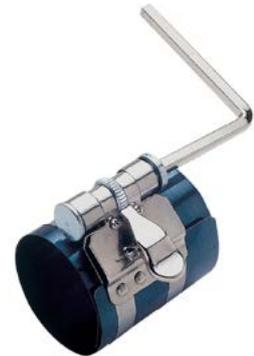
Outil indispensable pour la pose de segments neufs sur un piston lors d'une réfection moteur. Ce compresseur de segment allie efficacité et simplicité d'utilisation car il maintient les segments dans leur position une fois montés sur le piston, tout en permettant d'insérer l'ensemble dans la chemise du moteur. Cet outil vous fera gagner un temps de pose considérable sans risquer la casse d'un segment. Livré avec une clé de serrage.
