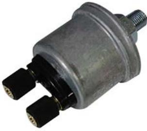
Capteur de pression d'huile spécialement adapté à un montage sur platine sandwich grâce à son filetage en 14 x 150. Ce capteur permet d'obtenir en temps réel la pression d'huile moteur et du circuit de lubrification depuis l'habitacle par le biais d'un manomètre de pression d'huile (vendu séparément).
