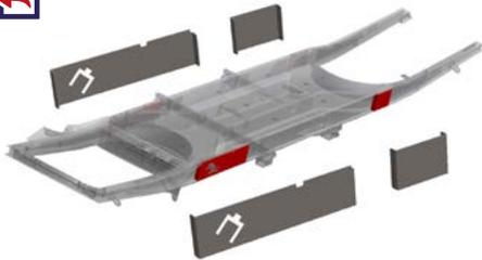
Renforts conçus par le 2CV Méhari Club de Cassis pour rigidifier les points d'ancrage des essieux avant et arrière sur la plateforme.
