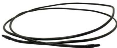
Tuyau de frein renforcé, assurant la liaison entre le maître-cylindre de frein et le répartiteur de frein arrière. Particulièrement exposé aux chocs et aux projections, il reçoit une protection rigide en PVC qui le recouvre entièrement, le rendant plus résistant. Ce tuyau de frein renforcé est indispensable pour ceux qui souhaitent partir à l'aventure avec leur auto ou s'engager en compétition.
