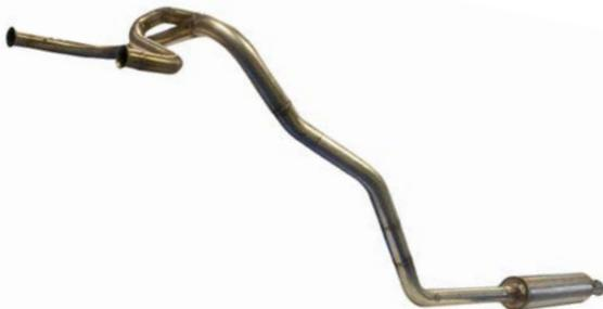
Cette ligne d'échappement 602 cc a été spécialement conçue pour optimiser les performances du bicylindre Citroën. Sa forme originale a été développée à partir de tests réalisés en banc d'essais. Entièrement fabriquée et assemblée à la main.
