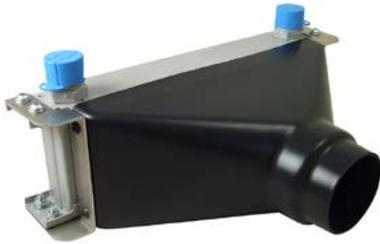
Cette écope d'air permet d'optimiser et de canaliser le flux d'air afin de réduire et de maintenir stable la température du refroidisseur d'huile, en empêchant ainsi toute surchauffe de l'huile moteur. Elle est spécialement étudiée pour être montée sur le refroidisseur d'huile réf. 1820341 et doit être accouplée avec un pack d'admission d'air réf. 1821010 ou 1821020.
