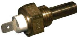
Capteur de température d'huile spécialement adapté à un montage simplifié en lieu et place du bouchon de vidange grâce à son filetage en 16 x 150. Ce capteur permet d'obtenir en temps réel la température de l'huile moteur depuis l'habitacle par le biais d'un manomètre de température d'huile (vendu séparément).
