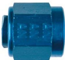
Obturateur permettant de condamner l'orifice d'entrée ou de sortie de la platine sandwich dans le cas d'un montage sans ajout d'un refroidisseur d'huile additionnel sur le circuit de lubrification.
